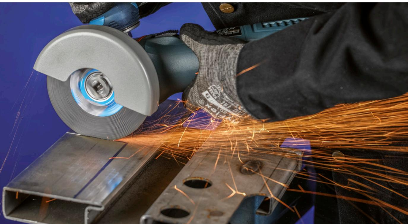
PFERD bietet POLIVLIES-Fächerscheiben in unterschiedlichen Korngrößen, Durchmessern und Ausführungen. Diese eignen sich insbesondere für die Bearbeitung von großen Flächen aus Edelstahl (INOX).
