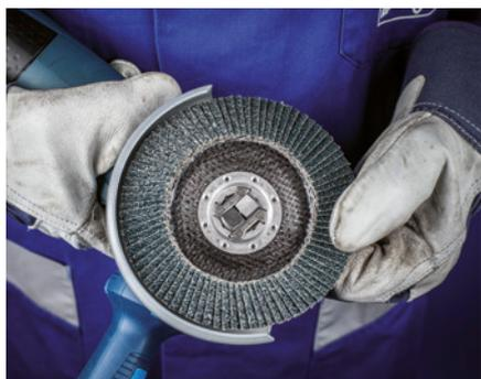
Setzen Sie das Werkzeug formschlüssig auf die X-LOCK-Aufnahme.
