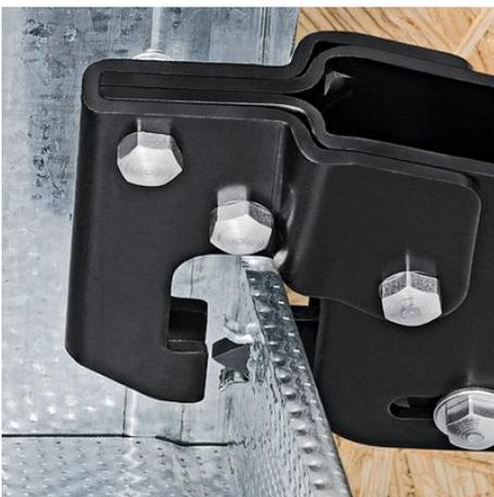
Das Stempelwerkzeug wird durch die Profilbleche gedrückt
