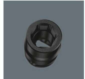
Das Sechskantprofil ermöglicht die Übertragung hoher Kräfte und belastet die Kanten der Schraubenmutter bzw. des Schraubenkopfes weniger als ein Zwölfkantprofil. Feinverzahnte Knarren machen darüber hinaus durch ihren kleinen Rückschwenkwinkel den Einsatz eines Zwölfkantprofils auch in beengten Raumverhältnissen überflüssig.
