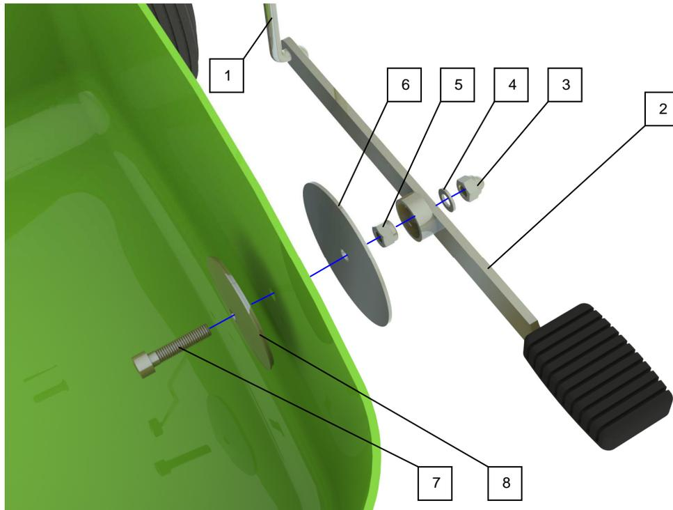
Nach dem Einfädeln des Fußpedals (2) über die Hubstange (1), wird das Fußpedal mit den dazugehörigen Montageteilen (3, 4, 5, 6, 7, 8), wie im Bild oben zu sehen, befestigt. **Die selbstsichernde Hutmutter (3) wird dabei soweit angezogen, dass der Fußhebel ohne zu wackeln, leichtgängig betätigt werden kann.**
