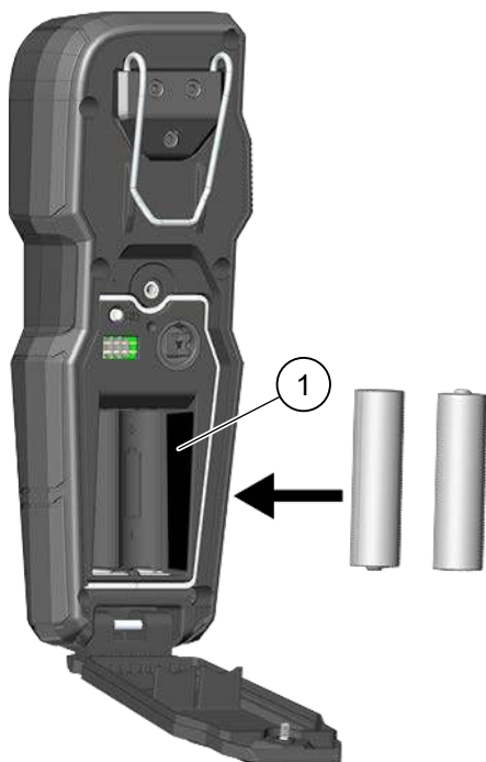
Figur 1. Installation af fjernstyringsbatterier
