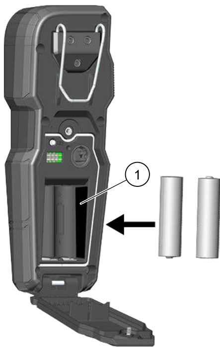
Bild 1. Installera fjärrstyrningens batterier
