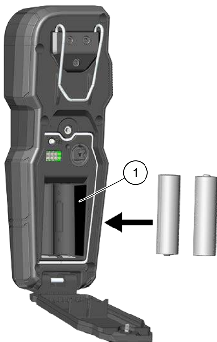
Figura 1. Installazione delle batterie del telecomando
