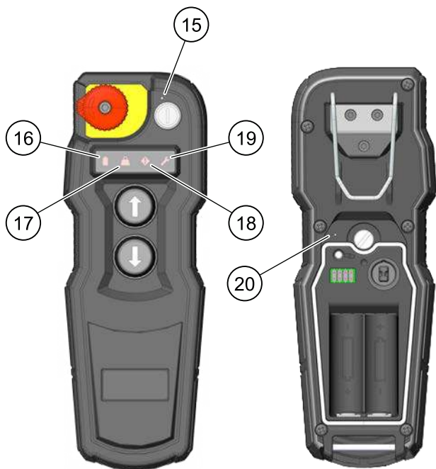
Bild 5. Fjärrstyrningens LED-indikatorer och -varningar
