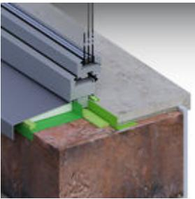
Lösungsmöglichkeit: Innen: ME500 TwinAktiv EW mit SP025 Fensterfolienkleber Öko I Mitte: FM230 Fensterschaum+ I Außen: TP600 illmod 600, ME500 TwinAktiv EW mit SP025 Fensterfolienkleber Öko, SP525 Hochbaufugen-Dichtstoff mit PR102 PE-Rundschnur
